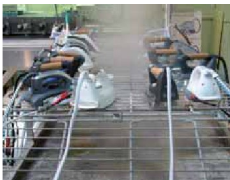
Záběr z testu odolnosti parních stanic vůči zanášení vodním kamenem.
