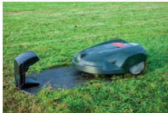
Husqvarna Automower 220 AC: Při vybití baterií se sekačka sama zajede nabít do základnové stanice. Proti náhodnému zapnutí je chráněna PINem.
