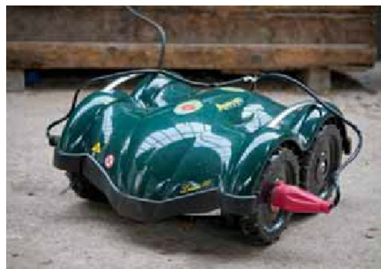
Lizard Mower S 14: Sekačka se nabíjí pomocí nabíjecích kabelů.
