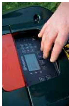
Husqvarna Automower 220 AC: Při vybití baterií se sekačka sama zajede nabít do základnové stanice. Proti náhodnému zapnutí je chráněna PINem.
